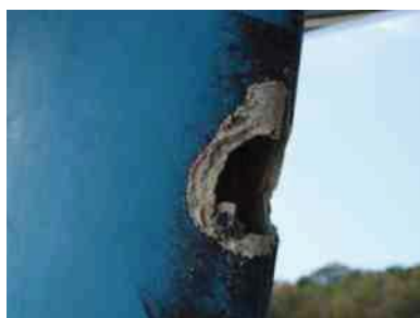
Het gat in het roerblad van de Bluenose, als gevolg van een aanvaring met een walvis.
